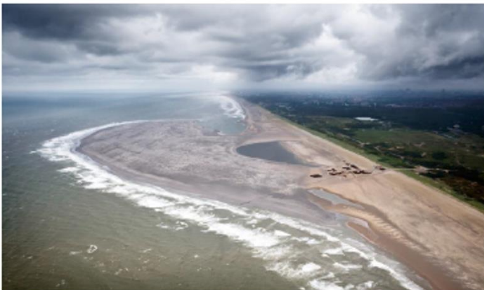
Figura 8.26 - Deposição de um elevado volume de areia numa única operação (The Hague, Holanda)
